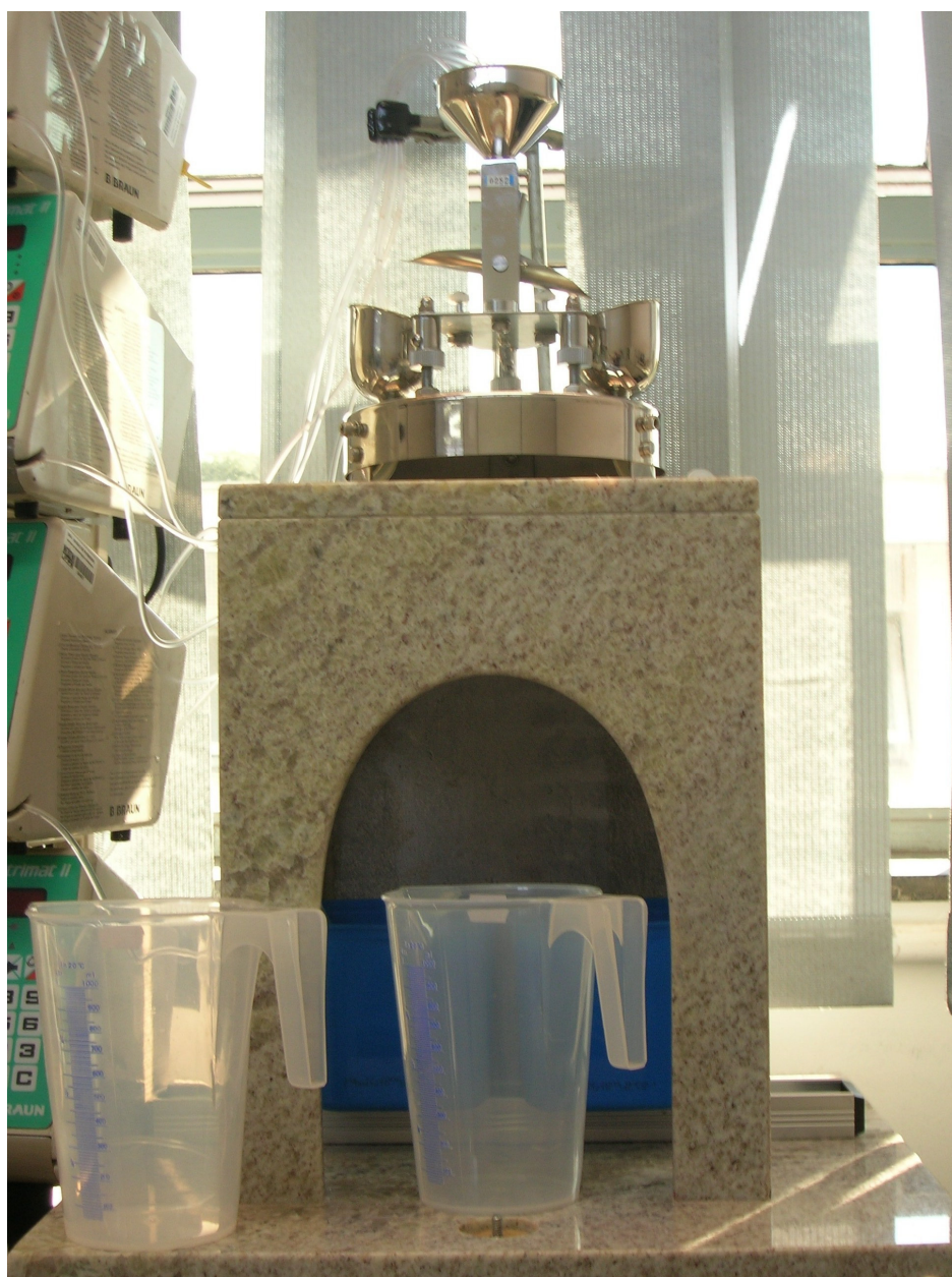
Figura 2 – Capela para testes de pluviômetros
